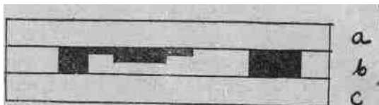
Rys. 3. Papier pigmentowy zetknięty z papierem do przenoszenia: a) papier do przeniesienia, b) warstwa światłoczuła z miejscami zgarbowanymi, c) podłoże.
